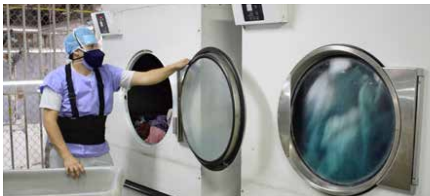
Las cuatro lavadoras centrífugas industriales procesan en cada carga hasta 300 libras.
